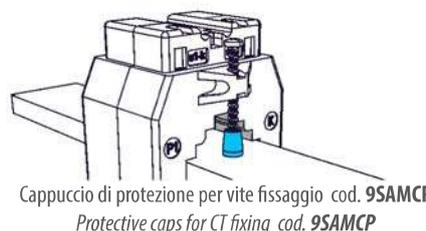
Cappuccio di protezione per vite fissaggio cod. **9SAMCP**
